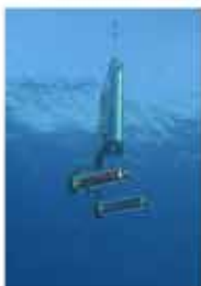
法国 HYDROPTIC 公司 UVP 水下颗粒物和浮游动物 图像原位采集系统
