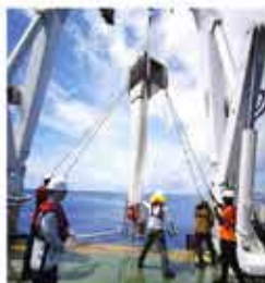
德国 HYDRO-BIOS 公司 MultiNet 浮游生物多联采样网
